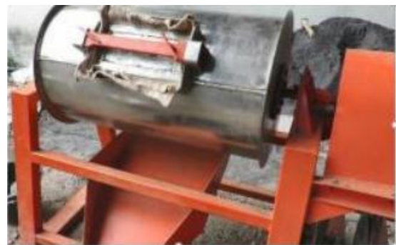
Gambar 1. Alat Grinding untuk pembuatan Semen Geopolimer Metode Kering
