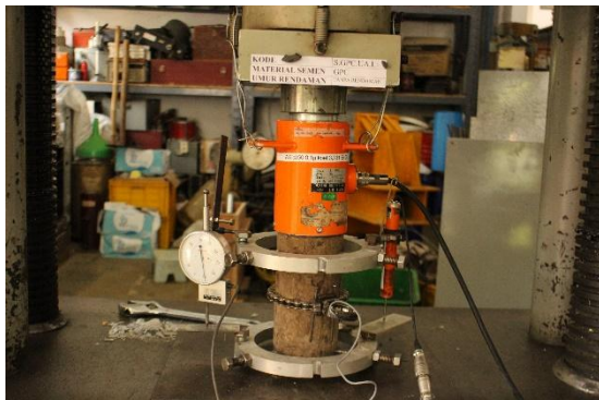
Gambar 4. Setup uji kuat tekan; modulus elastisitas; dan Poisson's ratio
