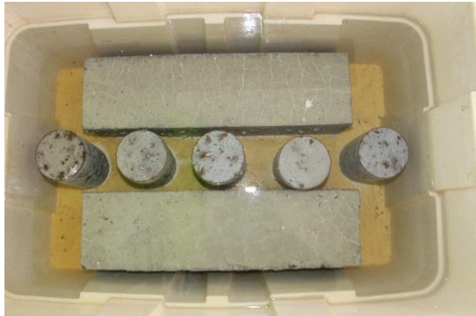
Gambar 3. Perendaman beton GPC dan PCC pada larutan MgSO_4
