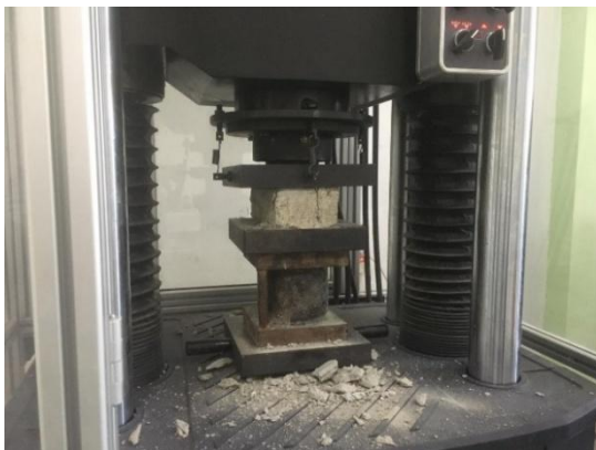
Gambar 2. Pengujian kuat tekan benda uji bata beton ringan
